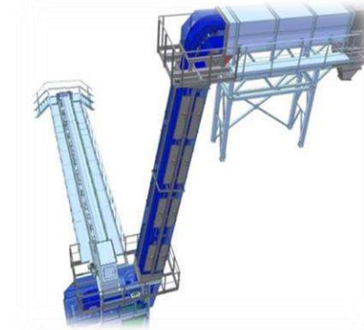
Вертикальные и крутонаклонные конвейеры
